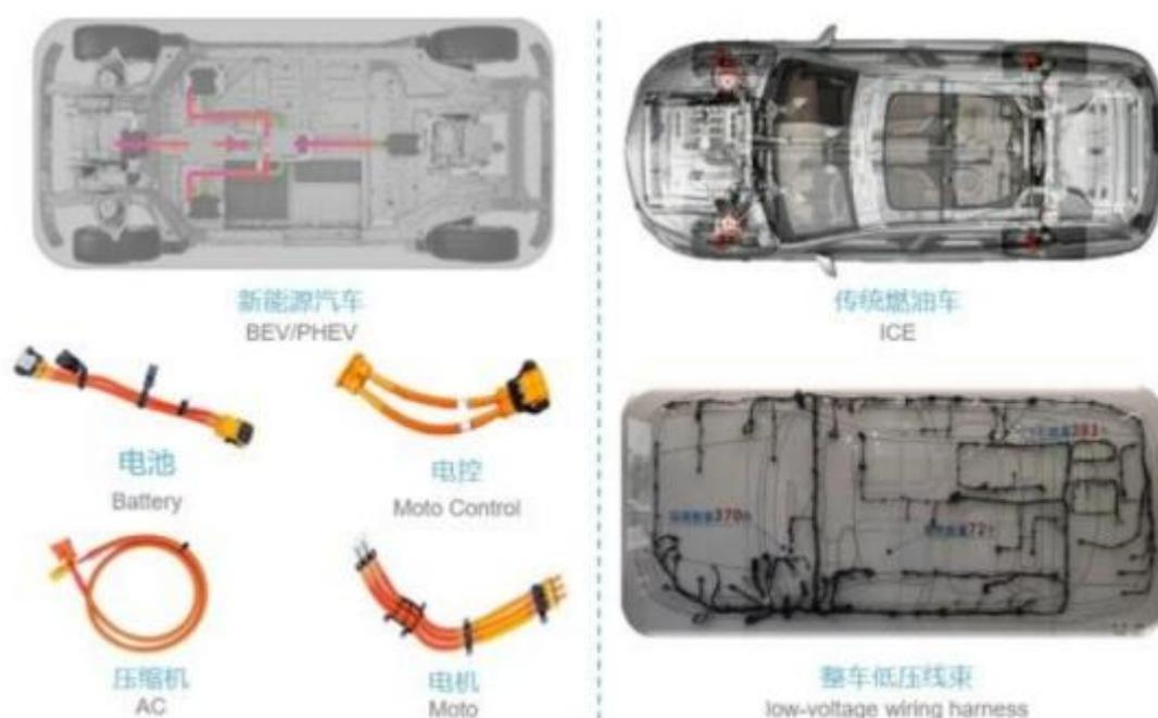
图 9：新能源和传统燃油车汽车线束
