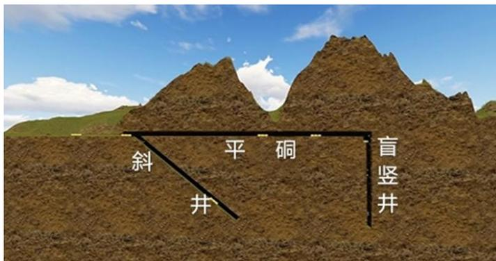
图 3：萤石采矿开拓系统示意图
