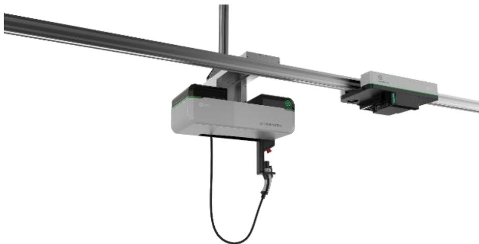
针对新能源充电市场，公司创新性推出了智慧共享充电系统。自2022年6月该系统首次在江苏省苏州市成功试点应用后，截至目前，已在苏州、无锡、北京、南京、南通、盐城、扬州、银川、绍兴、上海、青岛等多地建设投运。智慧共享充电系统包含智能机器人、共享充电桩、运行轨道以及运营管理平台等部分，利用机器人控制技术、人工智能技术和智能调度算法，通过机器人将空闲充电桩搬运到指定车位供车主充电。该系统具备以下主要优势：突破传统“一位一桩”的模式，通过机器人实现充电桩和车位的分离，从“车找桩”变为“桩找车”，为用户提供充电便利性；通过共享充电基础设施的方式，降低整体建设以及基础设施成本，实现最优的投入产出比；通过整体的有序充电规划，避免无序同时充电对配网带来的冲击，降低配网增容的压力。
