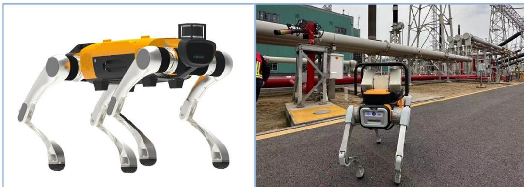
四足巡检机器人搭载多种感知模块，实现室外场景全覆盖无人化自主巡检，实时监测环境，自主采集、识别、运算和诊断，及时发现设备故障，辅助人工运维巡检。机器人具备以下功能：自动绕障、温度缺陷识别、表计识别、缺陷识别告警、环境监测、智能数据分析。相较于轮式巡检机器人，四足巡检机器人越障能力和地形适应能力大幅提升，可适用于多楼层室内环境，非规则路面的室外巡检场所，在电力、消防、矿山、野外侦查等其他行业特殊环境有应用优势。目前已在安徽等地多个变电站应用落地。报告期内，公司对四足机器人的功能和操作能力进行了进一步的升级拓展。
