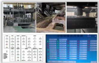
图 13.危险作业自动化-电解槽清渣自动化
