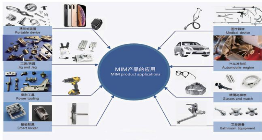
图：金属注射成型喂料应用图
