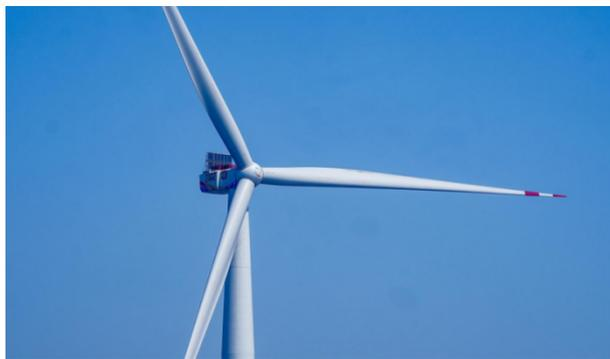
“启航号” 20MW 漂浮式海上风电机组
