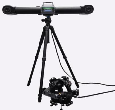
广州江河三维光学扫描仪：无需贴点即可完成超高精度动态三维测量
