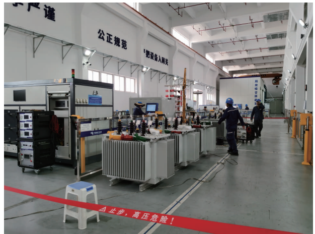
开展江村区域仓配网变压器检测，助力电网物资质量提升。
