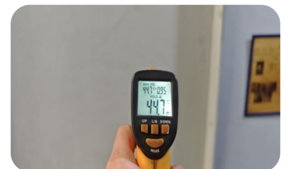
改善后炉体温度：炉门上方 57.6°C，炉壁 44.7°C
