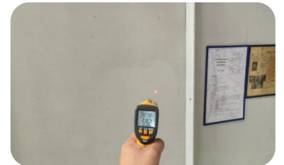
改善前炉体温度：炉门上方 300.8°C，炉壁 59.2°C
