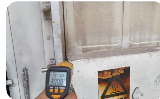
改善前炉体温度：炉门上方 300.8°C，炉壁 59.2°C
