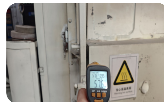
改善后炉体温度：炉门上方 57.6°C，炉壁 44.7°C
