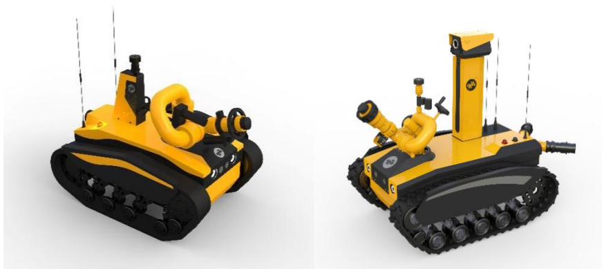
消防灭火机器人
